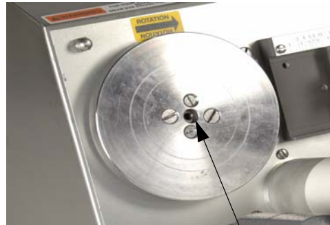
Furo-Piloto da Base do Alojamento da Lâmina
