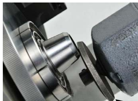
TRIMVAC ® -Klinge(n) Hinweis: Nabe der Schleifscheibe ist auf die Klinge ausgerichtet
